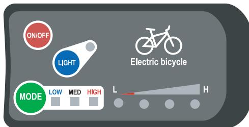
Чтобы включить электрорежим, удерживайте красную кнопку ON/OFF нажатой в течение 2-3 секунд. Затем выберите один из трех режимов работы электромотора при помощи зеленой кнопки MODE – после этого, каждый раз, когда вы будете начинать крутить педали, будет включаться и электромотор. Если вы прекратите крутить педали, электромотор выключится до тех пор, пока вы снова не начнете крутить педали. Чтобы выключить электрорежим, снова нажмите и удерживайте кнопку ON/OFF нажатой в течение 2-3 секунд.
