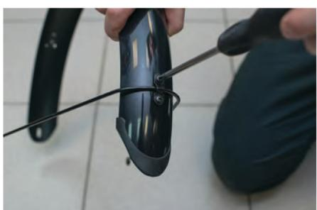
3б) Поместите крыло над колесом в вилку так, что бы язычок крепления крыла находился сзади верхней части вилки напротив отверстия крепления крыла к вилке.
