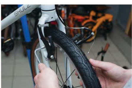
Если необходимо, открутите на один оборот гайку крепления колодки и отрегулируйте положение колодки. Затяните гайку крепления колодки и проверьте снова положение колодки (шестигранник 5 мм, усилие 5 Н·м).
