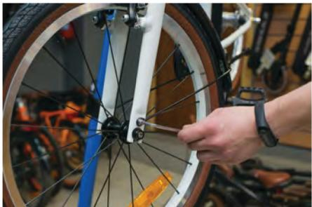
3d) Используя болты и шайбы крепления усов к вилке, закрепите усы с обеих сторон на вилке, отрегулировав их положение (шестигранник 4 мм).
