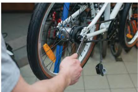
3с) Затяните гайки оси задней втулки (ключ рожковый: 15, 17 мм, усилие 35 Н·м).
