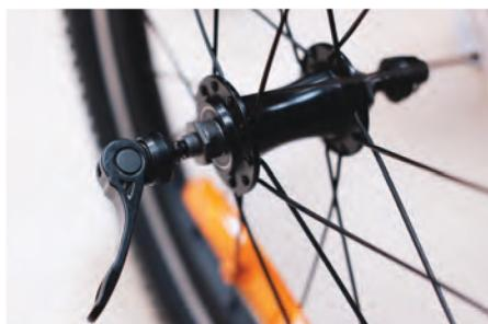
1b) Переверните велосипед и закрепите колесо в вилке, закрутив гайку с одной стороны эксцентрика и затянув рычаг с другой.
