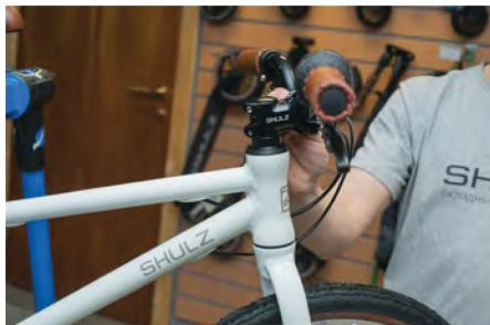
2e) Затяните болты так, чтобы расстояние между крышкой выноса и самим выносом сверху и снизу было одинаковым (шестигранник 4 мм, усилие 5 Н·м).
