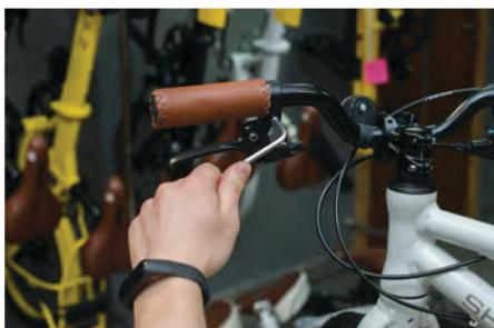
7а) Открутите болт крепления тормозной ручки (шестигранник 5 мм).
