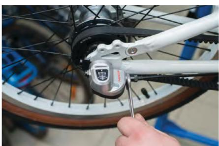
6g) Затяните контргайку регулировочного болта на переключателе планетарной втулки (ключ рожковый 10 мм, усилие 4 Н·м).
