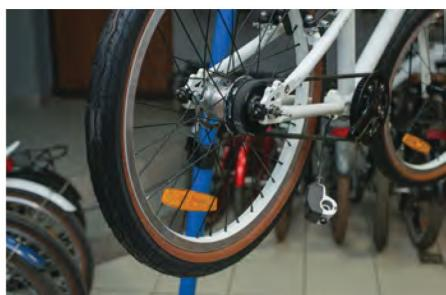
3a) Открутите на два оборота гайки оси задней втулки (ключ рожковый: 15, 17 мм).
