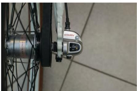
6f) Глядя в окошко индикатора на переключателе планетарной втулки, отрегулируйте положение желтого индикатора откручиванием или закручиванием регулировочного болта переключателя планетарной втулки так, чтобы он на второй передаче стоял между двух белых полос-индикаторов.
