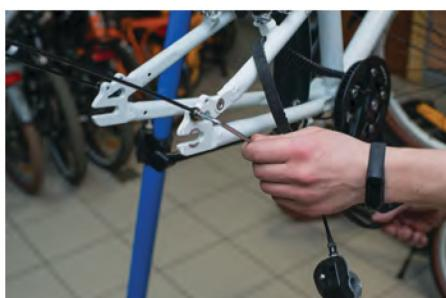
4j) Используя болты и шайбы крепления усов к раме, закрепите усы с обеих сторон на раме, отрегулировав их положение (шестигранник 4 мм).
