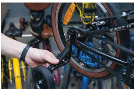
2d) Установите кронштейны доп. колес на ось продольными регулировочными отверстиями.
