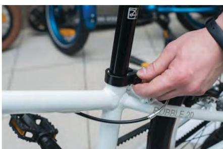
Если седло проворачивается при закрытом эксцентрике подседельного хомута, откройте эксцентрик подседельного хомута и подтяните руками гайку с обратной стороны эксцентрика подседельного хомута на пол-оборота.
