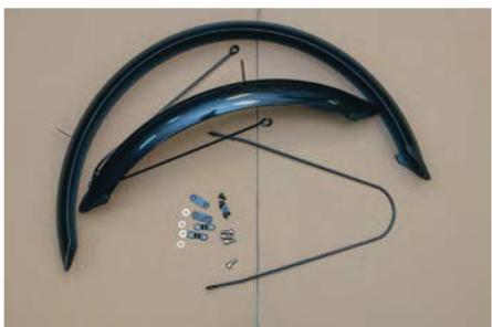
3а) Если не установлены, установите усы крепления крыла на крыло, используя крепеж из набора крыльев (отвертка PH2).
