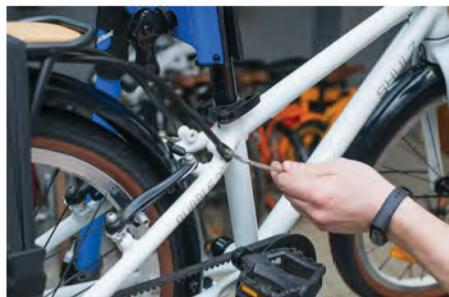
5c) Затяните 4 болта крепления багажника (шестигранник 4 мм, усилие 10 Н·м).
