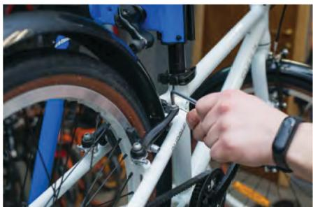
4n) Затяните болт крепления тормозного троса, установив тормозной трос в необходимое положение
