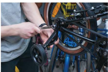
2e) Оденьте шайбы и накрутите контргайки на ось задней втулки.
