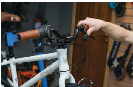
Если у вас Shulz Bubble 16, тормозная ручка должна быть справа по ходу движения, а тормозная рубашка слева под рулем.
