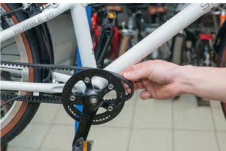
4л) Установите болты или гайки обоих натяжителей и отрегулируйте положение колеса натяжителями так, чтобы колесо стояло ровно относительно велосипеда, а ремень, при нажатии на него рукой, не провисал больше, чем на 10 мм (шестигранник 3 мм, ключ рожковый 10 мм).
