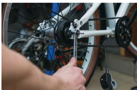
4м) Затяните гайки оси задней втулки (ключ рожковый: 15, 17 мм, усилие 35 Н·м).
