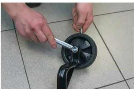
2б) Полностью открутите контргайки оси задней втулки и снимите шайбы (ключ рожковый 15 мм).
