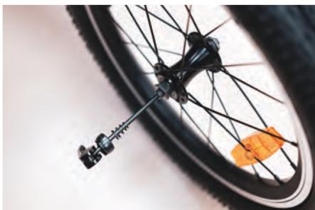
Переднее колесо крепится при помощи эксцентрика.
