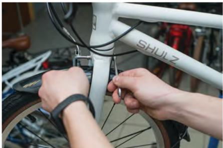
3c) Используя болт, шайбы и гайку крепления крыла к вилке, закрепите крыло, отрегулировав его высоту (шестигранник 5 мм, ключ рожковый 10 мм).
