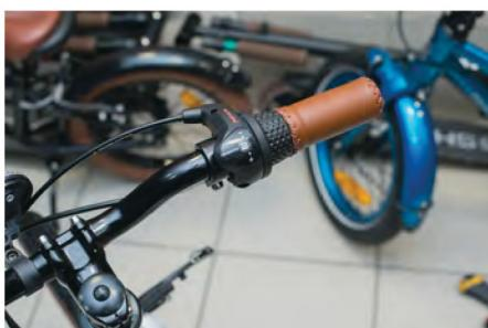
6д) Для регулировки передач планетарной втулки включите вторую передачу.
