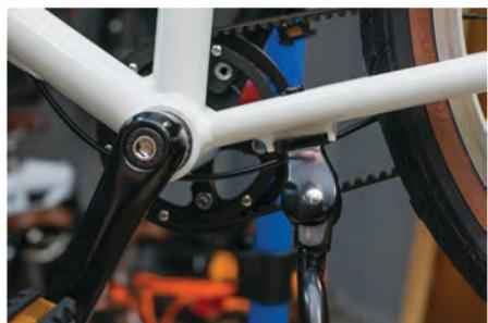
1c) Затяните болт крепления подножки
