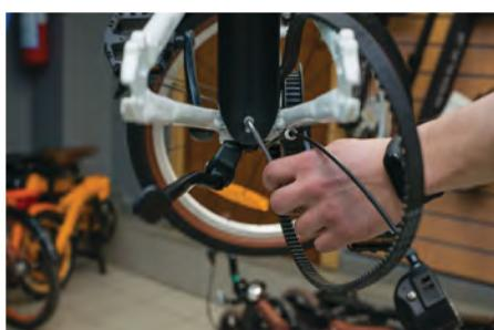
4i) Используя болт крепления крыла к креплению подножки, затяните болт (шестигранник 4 мм, отвертка PH2).
