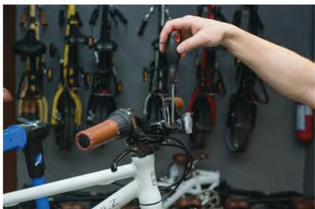
2i) Установите катофот из коробки с доп. деталями на руль (отвертка PH2).
