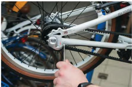
6e) Открутите контргайку регулировочного болта на переключателе планетарной втулки (ключ рожковый 10 мм).
