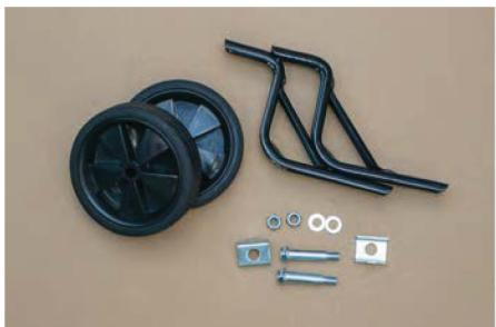
2а) Соберите доп. колеса, используя оси, шайбы, гайки, колеса и кронштейны (ключ рожковый 12, 13 мм, усилие 10 Н·м).
