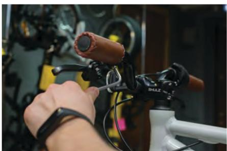
7c) Затяните болт крепления тормозной ручки (шестигранник 5 мм, усилие 5 Н·м).
