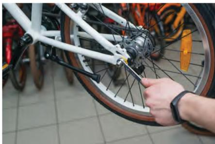
4b) Полностью открутите регулировочные болты или гайки
