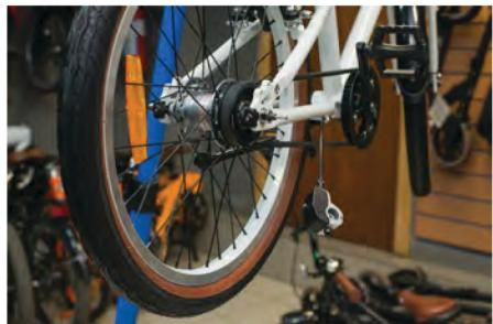
4a) Открутите на два оборота гайки оси задней втулки
