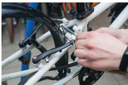
4h) Используя болт, шайбы и гайку крепления крыла к раме, закрепите крыло, отрегулировав его высоту (шестигранник 5 мм, ключ рожковый 10 мм).
