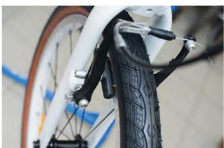
7d) Проверьте необходимость регулировки тормозных колодок. Они должны стоять параллельно ободу.
