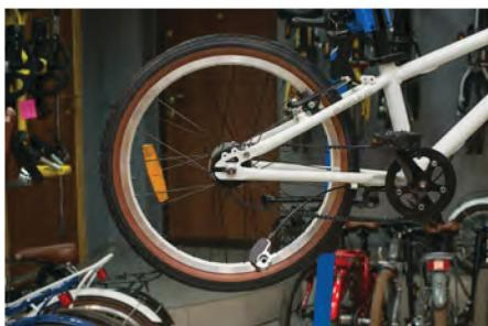
4c) Открутите болт крепления тормозного троса на лапке заднего тормоза, чтобы развести колодки в разные стороны, иначе колодки будут мешать снять колесо (шестигранник 5 мм).
