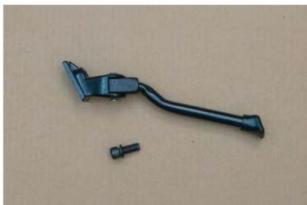
1а) Выкрутите из подножки болт крепления подножки.
