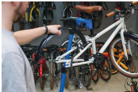
4g) Установите крыло на велосипед так, чтобы язычок крепления крыла оказался сверху перемычки верхних перьев напротив отверстия крепления крыла к раме.
