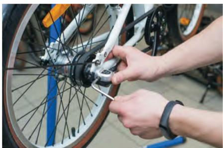
Если у вас Shulz Bubble 20, установите переключатель планетарной втулки на ось втулки да упора так, чтобы рубашка тросика была параллельна нижнему перу заднего треугольника велосипеда, и затяните болт переключателя планетарной втулки (шестигранник 5 мм, усилие 2 Н·м).
