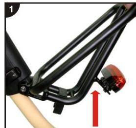
Поднимите багажник (если он установлен).
