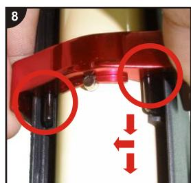
Наденьте кнопку защелки на направляющие корпуса защелки.
