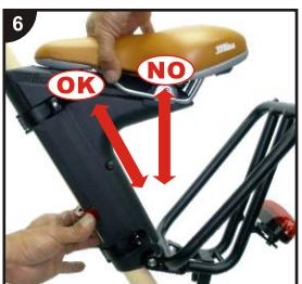
Отрегулируйте седло по высоте, передвигая корпус крепления вдоль задней трубы.
