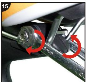
Гаечным ключом на 13 мм затяните с обратной стороны гайку с усилием 5,5—6,5 кг. Не перетяните ее!
