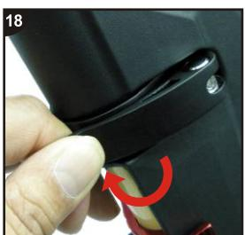
Убедитесь, что эксцентрик правильно установлен и настроен, и плотно затягивается на корпусе крепления.
