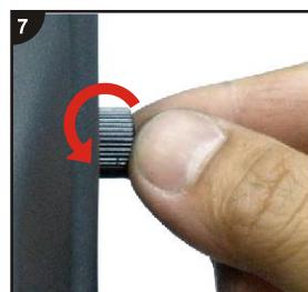
Слегка ослабьте гайки, если зажимы-эксцентрики закрываются слишком туго.
